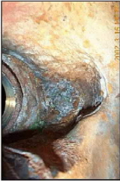
図6 原子炉容器上蓋に見つかった腐食劣化の状況(写真)
